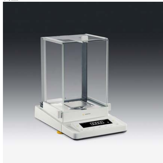
手动 DU 防风罩，门易于敞开，广泛开放的角度
